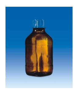
Gewindeflaschen aus Braunglas (Natron-Kalk-Glas) mit einer Ethylen-Acrylat-Beschichtung für erhöhte Sicherheit und Schraubkappe. Die Kunststoffummantelung reduziert die gefährliche Splitterwirkung von Glas beim Bruch erheblich. Die maximale Gebrauchstemperatur der beschichteten Flasche liegt bei 80 °C. Um die Beschichtung zu schonen, wird allerdings eine Reinigung bis max. 60 °C empfohlen.
